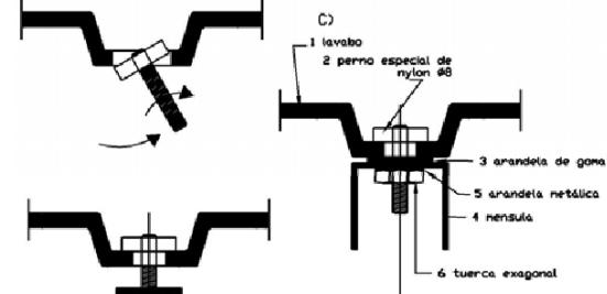
B) Montar la arandela de goma, descansar el lavabo sobre la ménnsula, situar la arandela metálica y roscar la tuerca de sujeción.
