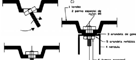
B) Montar la arandela de goma, descansar el lavabo sobre la ménsula, situar la arandela metálica y roscar la tuerca de sujeción.
