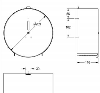
Portarrollos para montaje a pared, en acero inoxidable, acabado satinado, espesor de material 0,8mm, cerradura estándar Franke, con carcasa redonda con ventana de inspección, con accesorio de corte en los 2 lados de apertura, para 1 rollo con diámetro máx. de 260 mm, incluye tornillos y tacos.
